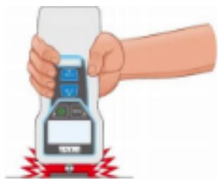
DSV / DST-2N / 5N / 20N / 50N tiene un tope mecánico para prevenir sobrecargas
